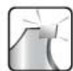
Diente con plaquita de Metal Duro soldada
